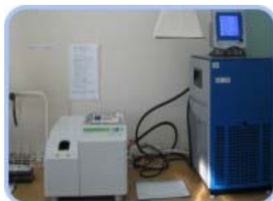
Fig. 3. TGA thermal analyzer.
